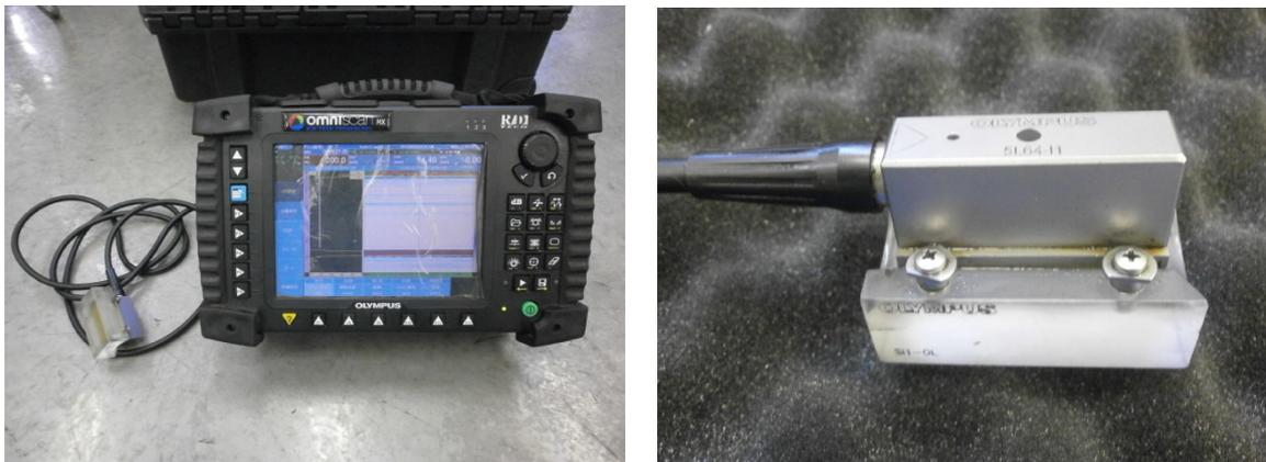
図19. フェーストアレイ超音波探傷器とプローブ
