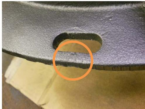
図15. 磁粉探傷試験 供試体
