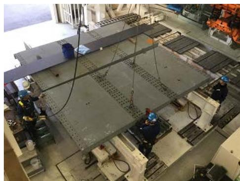
図8. 輪荷重走行試験 供試体
