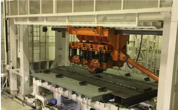
図10. 輪荷重走行試験機
