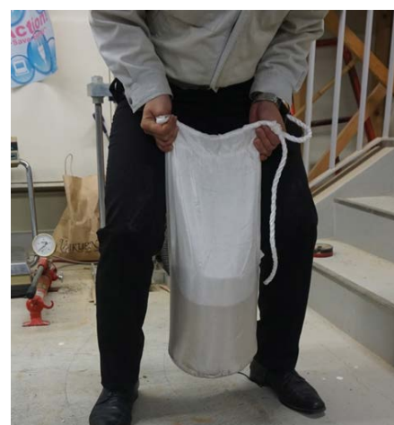
写真1 土のう中詰材の締固め作業
