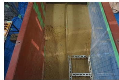
写真1 600Gal 加振後 (対策高 15cm)
