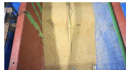
写真2 600Gal 加振後 (対策高 10cm)
