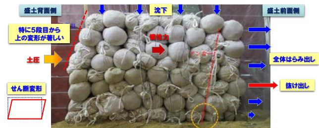
図6 加振後の土のう構造体の状況
