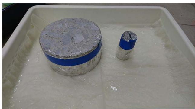
写真1 小径コアを用いた吸水試験の実施状況(左)と標準コアとの比較(右)
