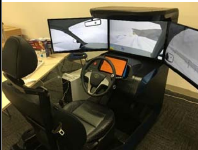
図 UC-win/Road Drive Simulator の外観と DS で再現した冬期路面の映像
