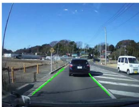
図 7 画像解析による区画線内の路面領域検出（左）、バーチャルリアリティ映像への適用（右）
