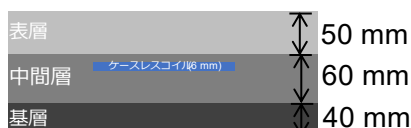
図 29. 直接埋設（型枠7）
