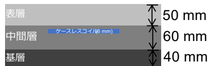
図 29 直接埋設（型枠6・型枠7）【再掲】
