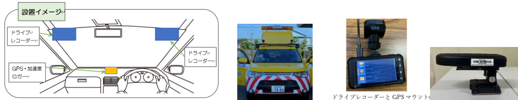
図2 道路劣化計測システムと設置方法
