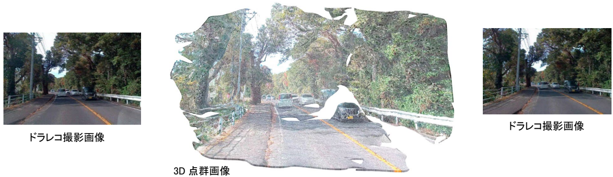
図5 ドライブレコーダーの動画（左右）から構築した3次元点群（中央）
