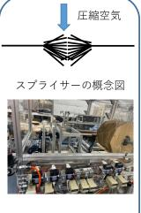
工程②:スプライサー により接合, および自 動巻取り
