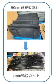
**工程①:連続繊維用に** カット(前処理) ※この工程は対象とする CFRPに依存するため自動化 はしていない
