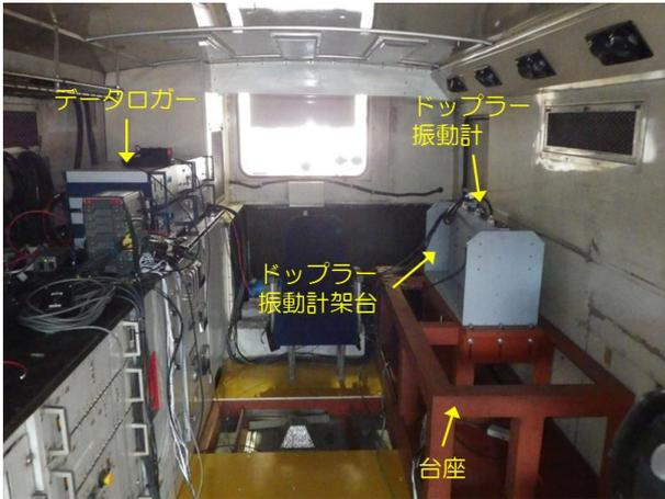
図 2.15 ドップラー振動計の設置状況
