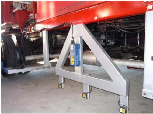
図 2.3 速度計の設置状況
