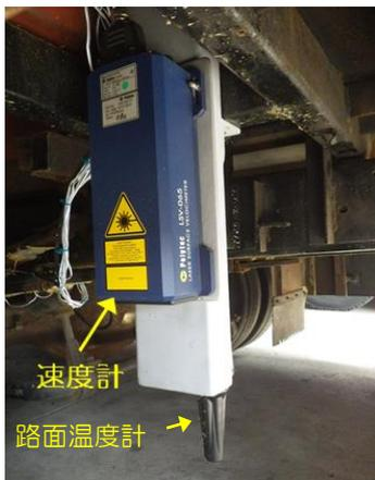
図 2.16 速度計および路面温度計の設置状況
