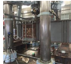
写真3 実大試験体による耐荷力実験
