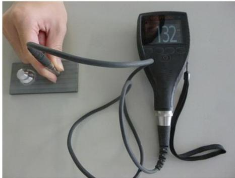
写真 2.6.3 電磁膜厚計
