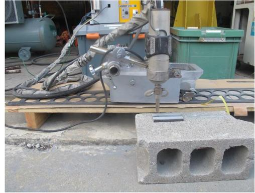
写真 2.6.5 半自動施工装置
