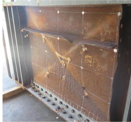
写真 4-16 試験終了後のウェブの面外変形状況
