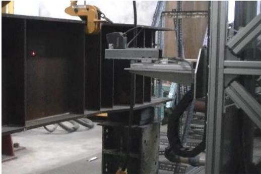
(b) せん断試験体用レーザー計測装置
