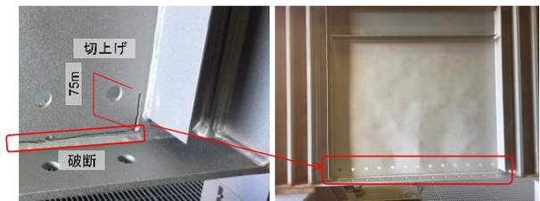
写真 4-9 大型桁試験体損傷模擬状況
