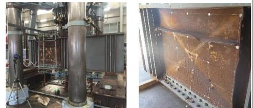
写真3 実大試験体による耐荷力実験
