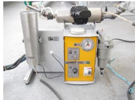
図 3.4.3 CS 施工装置（DYMET412k）
