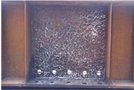
(b) 実腐食試験体損傷模擬状況
