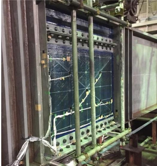
写真 4-14 補修後の腐食模擬試験体
