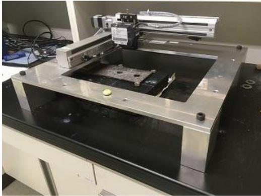
(a) 腐食鋼板用レーザー計測装置
