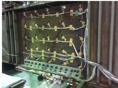
写真 4-11 当て板ボルト工法施工後の実腐食せん断試験体
