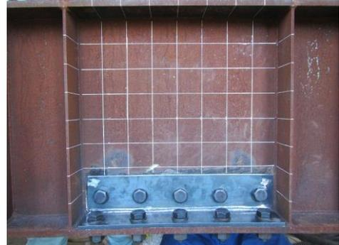
写真 4-4 当て板ボルト工法適用後の試験体例
