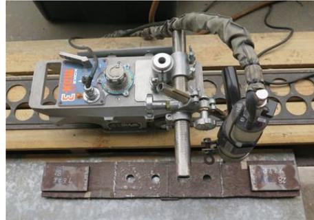
写真 3.4.4 半自動化施工装置
