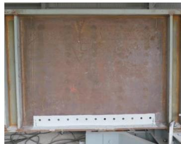
(b) Cold Spray 工法施工後の実腐食せん断試験体
