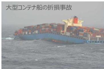
大型コンテナ船の折損事故 事故の原因分析 ⇒ 基準改正、国際提案
