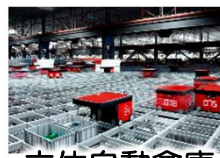
立体自動倉庫
