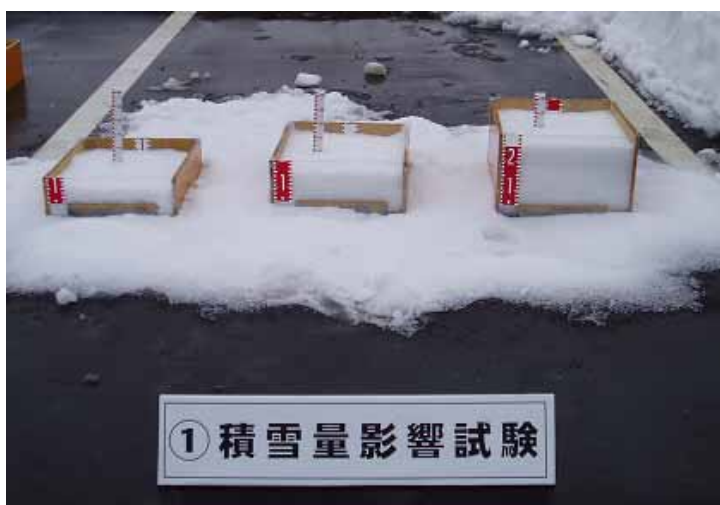
UCと白杖を使用した積雪影響試験の様子
