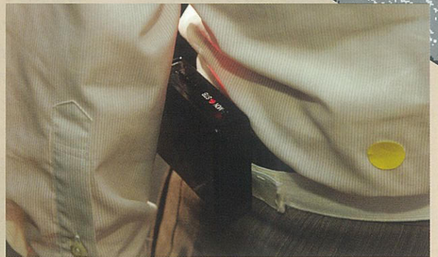
左腰の方位センサー。移動者の向きによって情報の内容は変化する。
