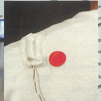
振動する部品がシャツの中に縫い付けられている。
