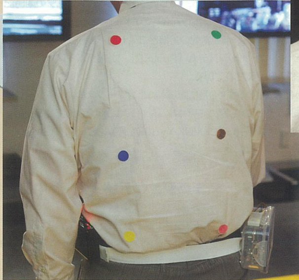
背中中の6ヶ所のポイントを振動させて点字を表現する。
