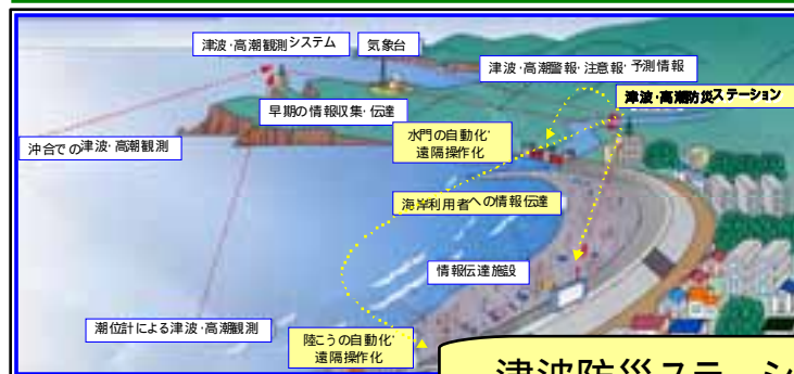
津波防災ステーション
