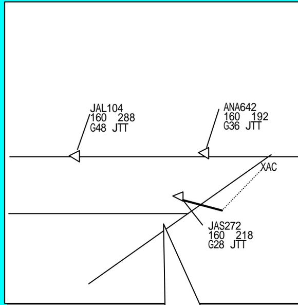
到着機の管制間隔を確保するための情報を算出しデータブロック上に表示させる。
