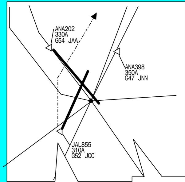
管制指示入力に対して一定時間先（15分程度）でのコンフリクト状態を検出した場合、予測飛行経路を表示
