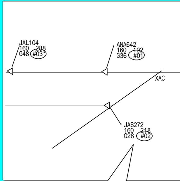
ターミナル移管ポイントへの到着順位、距離および間隔欠如のステータスを表示
