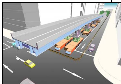
施工(一括架設)イメージ
