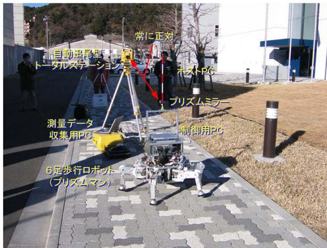
水陸境界域歩行ロボットによる自動測量システムの開発
