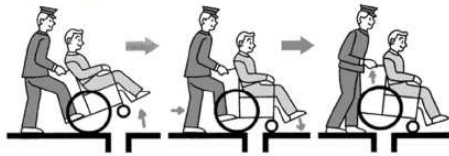
①わがわを上げる → ②溝を通過したらわがわを下ろす → ③後輪を浮かせきみにして溝を越える
