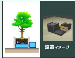
仮設式レインガーデンの構造概要と設置例
