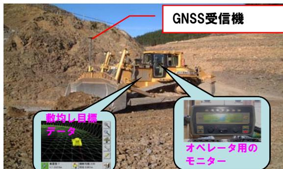
TSやGNSSを用いて建設機械あるいは作業装置の位置を計測し、施工目標高さに対する施工後の高さの差分をリアルタイムでオペレータに提供するシステム
