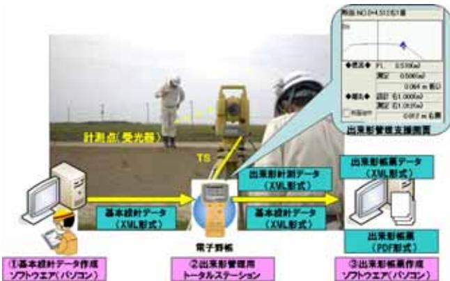
レベルやテープでの出来形計測に変えて、三次元設計データを搭載できる TS を用いて出来形計測を行い、計測結果を基に自動的に出来形管理帳票の作成を行うシステム。
