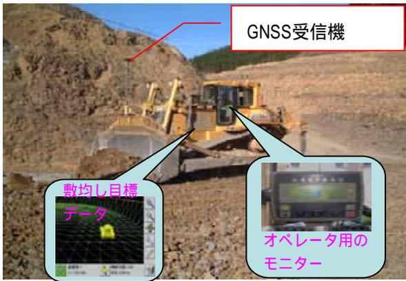
TSやGNSSを用いて建設機械あるいは作業装置の位置を計測し、施工目標高さに対する施工後の高さの差分をリアルタイムでオペレータに提供するシステム。
