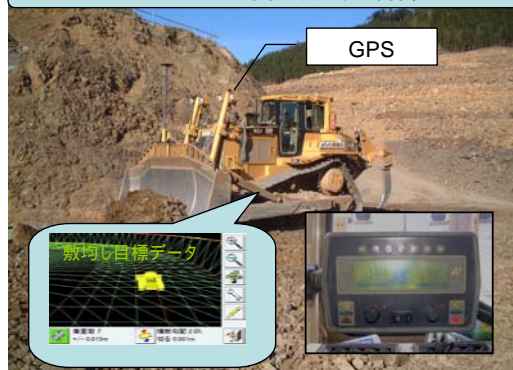
ブルドーザの自動敷均し制御
