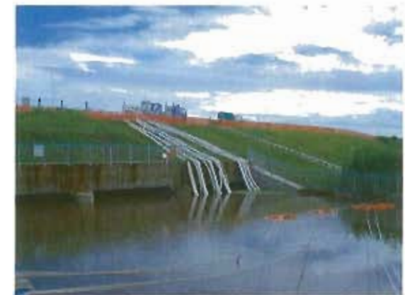
出動した排水ポンプ車 30m 3 /min(水力式);荒川上流河川事務所
