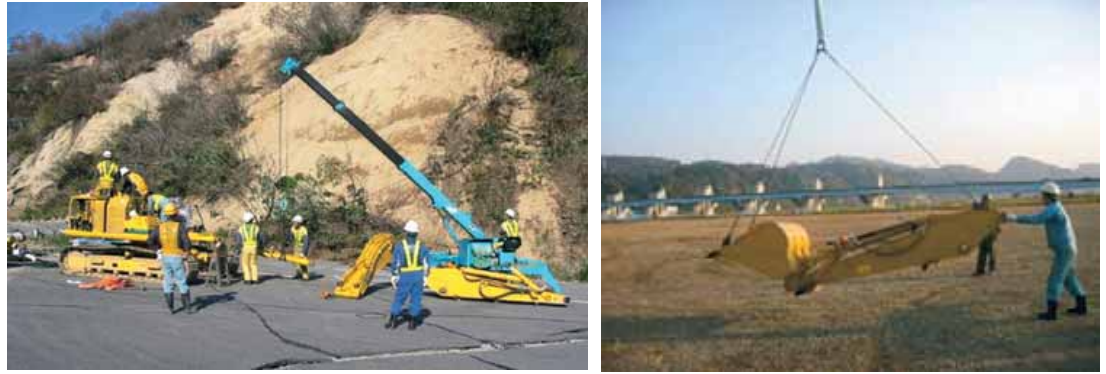
写真-19 中越地震時に分解空輸され現地で組立てる油圧ショベル(北陸地整提供)
