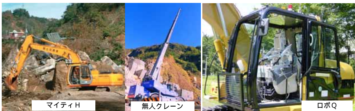
写真-32 遠隔操縦型建設機械（北陸地方整備局・九州地方整備局提供）
