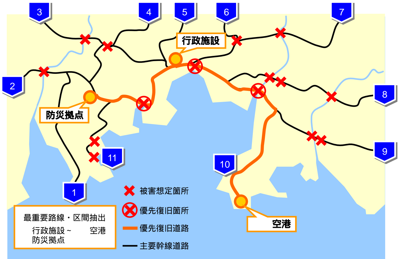
図-31 優先する復旧工事の選定例
