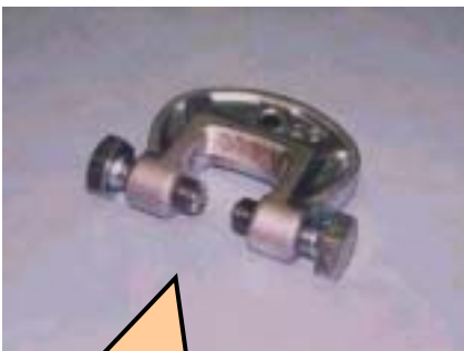
[ 型 ] 最も多用される治具であり、2枚の鋼板が重なる部分に使用する。
