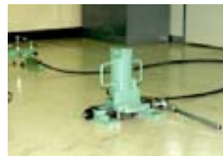
微調整治具 (横スライド爪付油圧ジャッキ)
