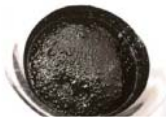
発泡剤による アスファルト合材の発泡状況
