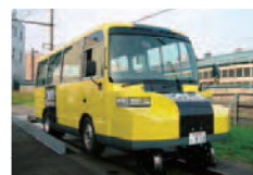
DMV (デュアルモードビークル) 線路と道路の両方の走行が可能な車両
