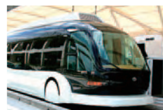
IMTS (インテリジェントマルチモードトランジット) 磁気誘導による専用道路部分と一般道路の両方を走行する車両
