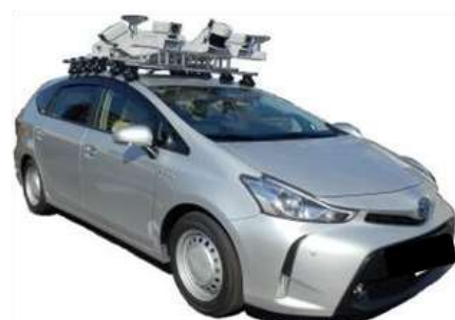
初期走行用MMS (計測コストを大幅に低減)
