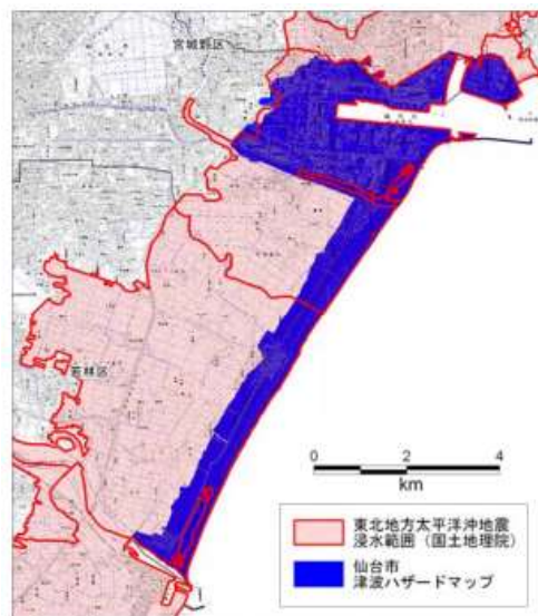
図 1 東日本大震災時の浸水範囲と従前の浸水想定範囲（仙台市の例） （東北地方太平洋沖地震浸水範囲 国土地理院資料より作図）
