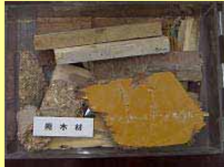
建設発生木材
