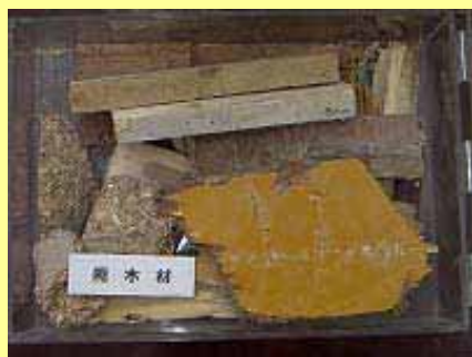
建設発生木材
