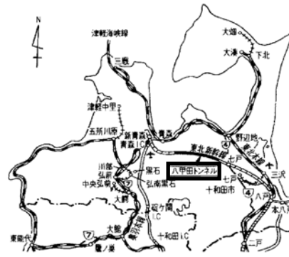
青森県天間林村から青森市に至る全長26km455mの陸上トンネル
