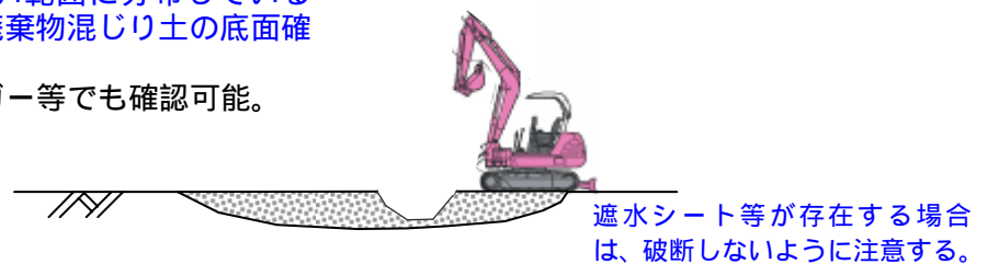
図3 - 1 (1) ケース A . 廃棄物混じり土の深度方向範囲の調査状況例 1
