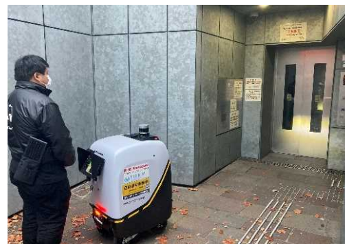
エレベータの呼出し
