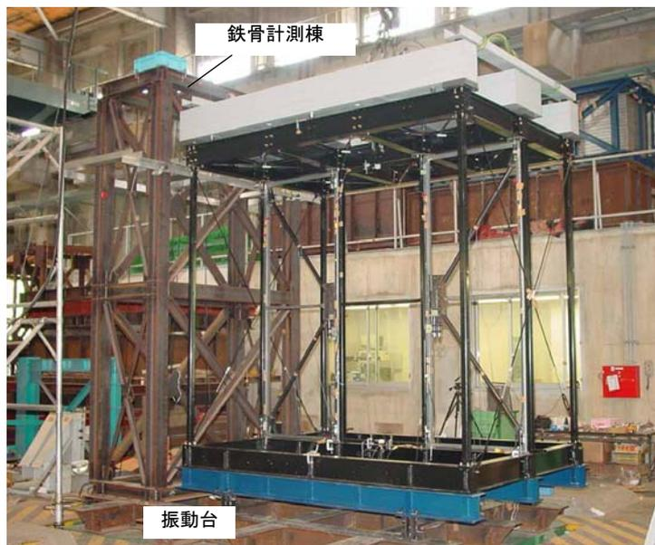
図 4-3 振動台実験試験体の設置状況（軽量鉄骨）
