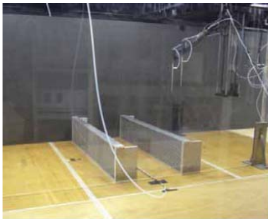
図5 パネル型のACFフェンスモジュールを用いた道路両端の2枚フェンス
