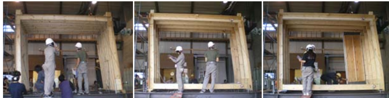
試験風景：左から、No.2 (足つなぎ無し)、No.1 (基本形)、No.6 (制振壁)
