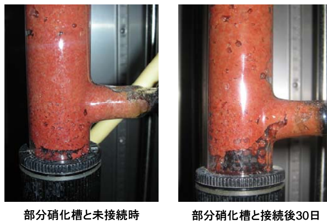
図 3.13 部分硝化槽と接続前後の ANAMMOX 槽
