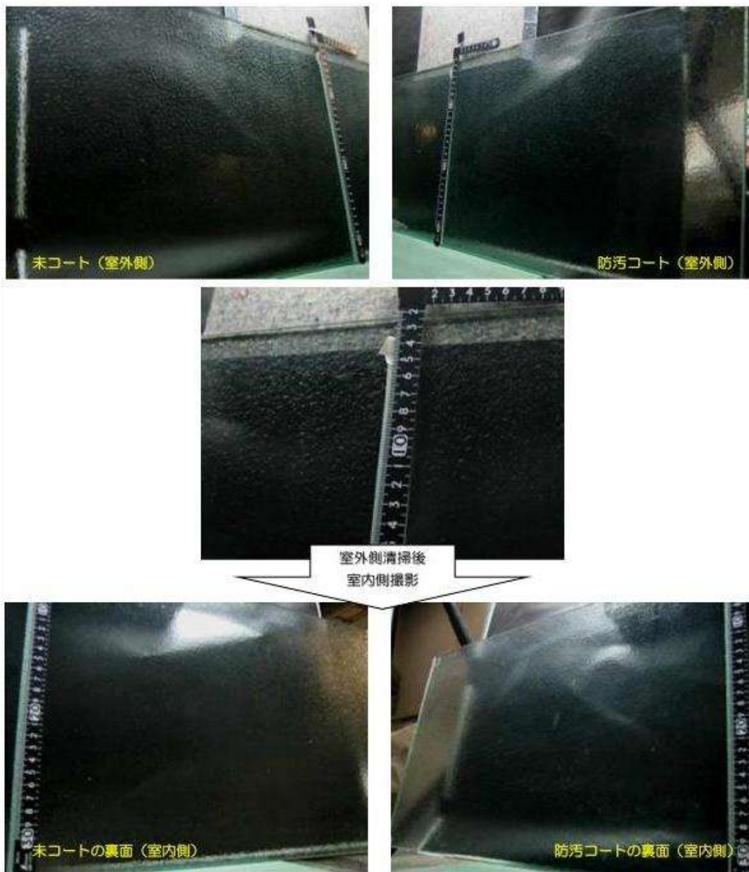
写真2-24 ガラスの汚損状況の詳細写真 (型板ガラス)
