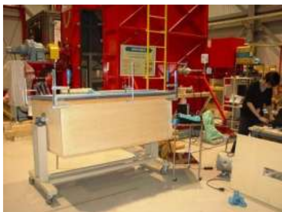
写真2-1 外装の有効開口面積の測定装置及び測定の様子
