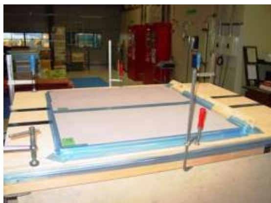
写真2-1 外装の有効開口面積の測定装置及び測定の様子
