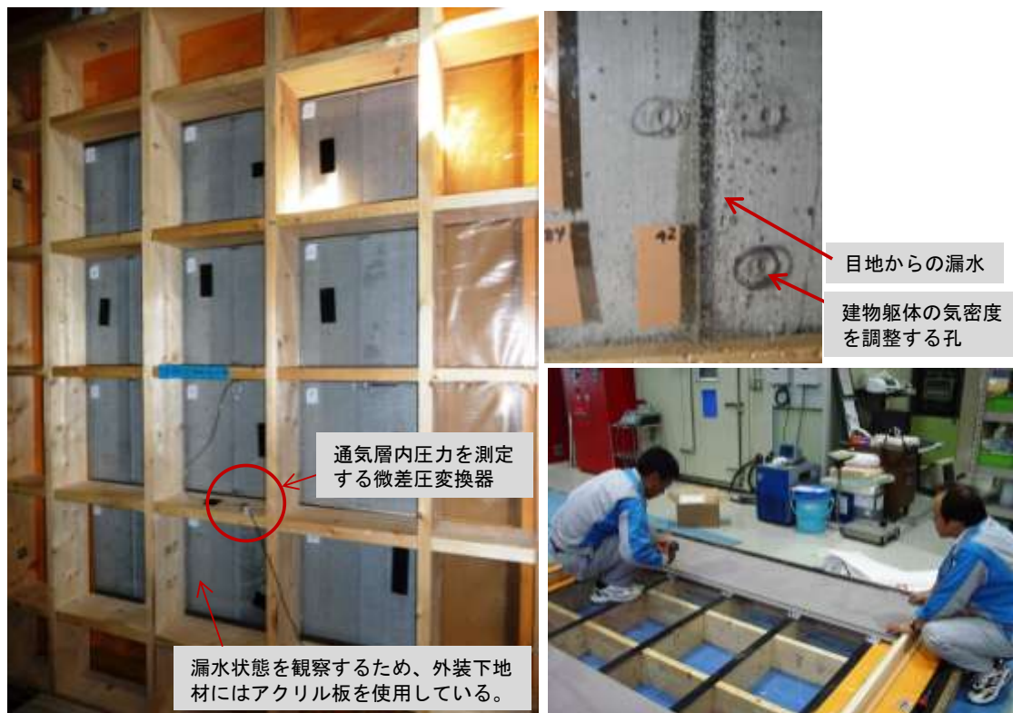
写真2-3 圧力ポートの設置及び、下地の隙間量の調整口
