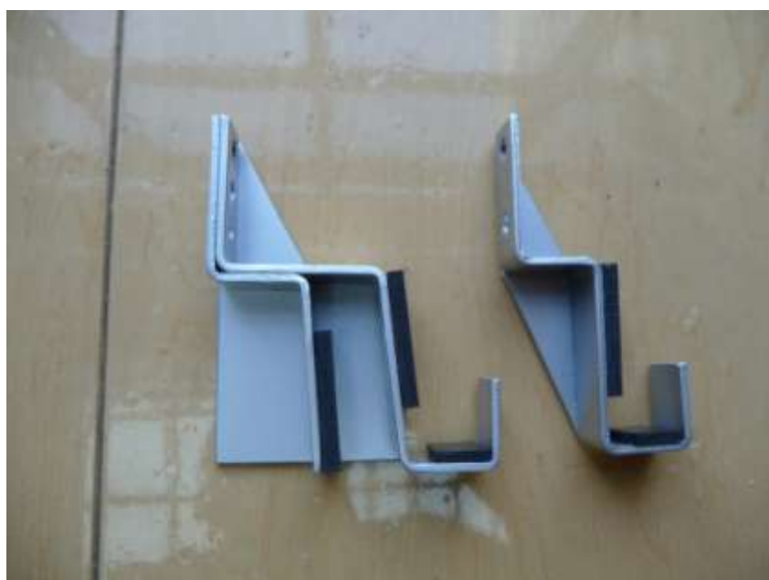
写真2-10 補強したガラス支持金具
