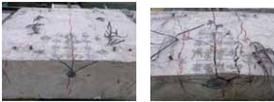
写真 - 2 破壊時の様子 (左 : S8 , 右 : T15)
