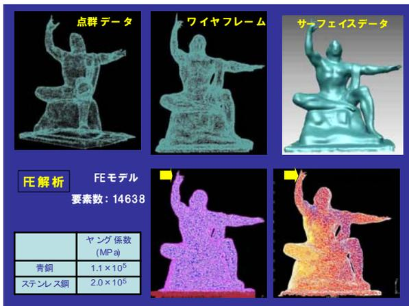
図-11 3D計測データを用いたFE解析
