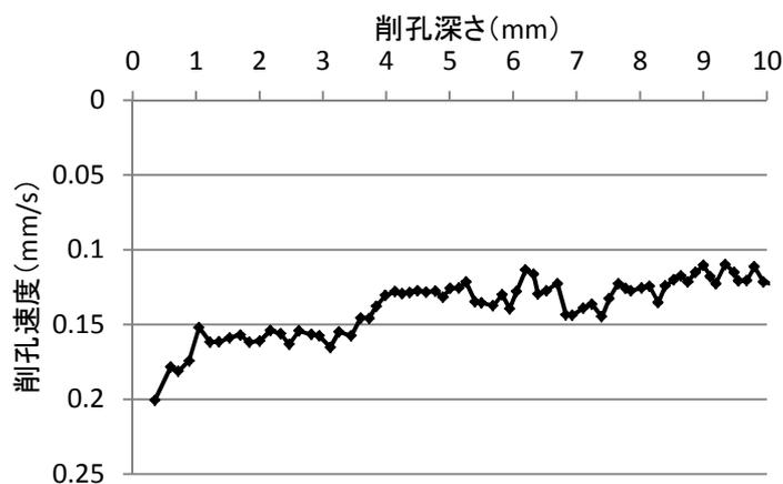
図 3-3 削孔深さと削孔速度の関係
