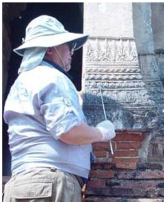
Fig. 10 漆喰接着破壊状況調査
