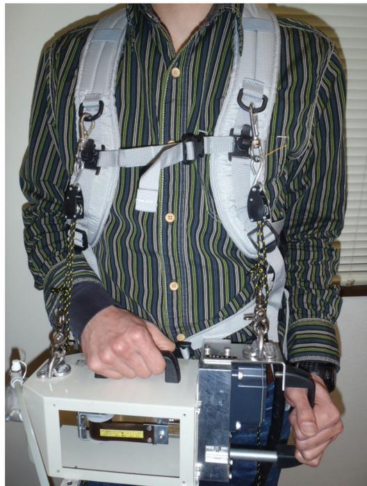
削孔試験機吊下げ写真
