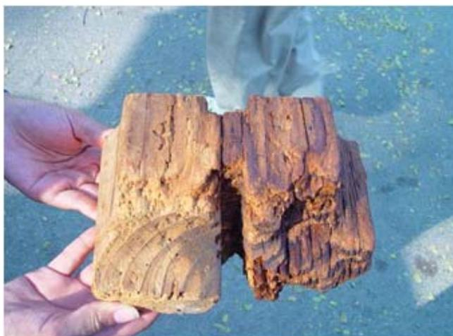
Fig. 44 サンプル (左側：無処理、右側処理済み)
