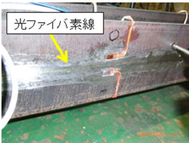
写真10 光ファイバ素線を用いた室内試験 (H21年度)
