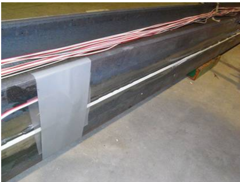
写真12 H型鋼の側面に接着した光ファイバセンサ（H22年度）
