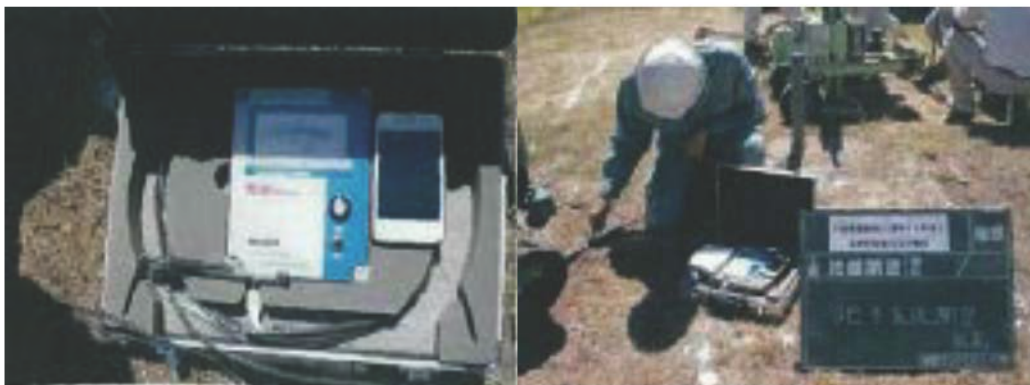
図-5.3 水位測定装置の例
