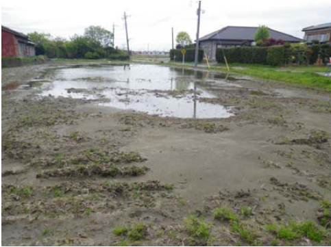
写真 3. 2. 122 宅地地盤の液状化に伴う大規模な噴砂状況
