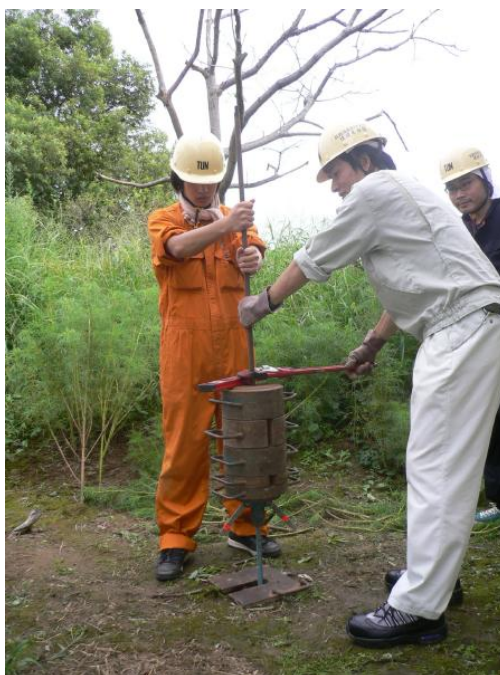
写真 3.2.50 試験状況（人力による回転貫入）
