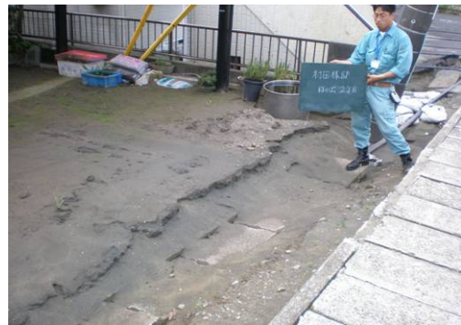
写真 3. 2. 122 宅地地盤の液状化に伴う大規模な噴砂状況
