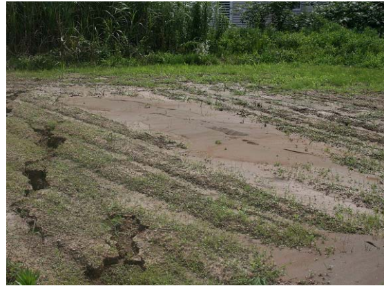
写真 3.2.44 農業用地内の噴砂 （長岡高専，尾上篤生氏撮影）
