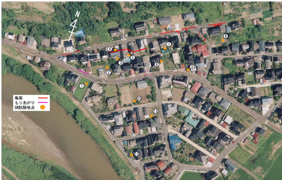
写真3. 2. 97 山本団地の地盤変状とスウェーデン式サウンディング位置（2007年7月19日八州撮影）
