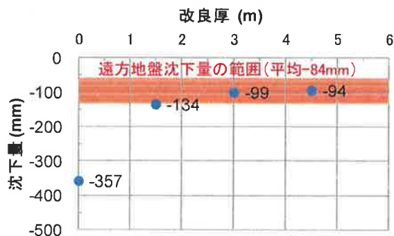
図 8 建物最終沈下量と建物直下の地盤改良厚さの関係 ( 1.5\text{m/s}^2 加振)
