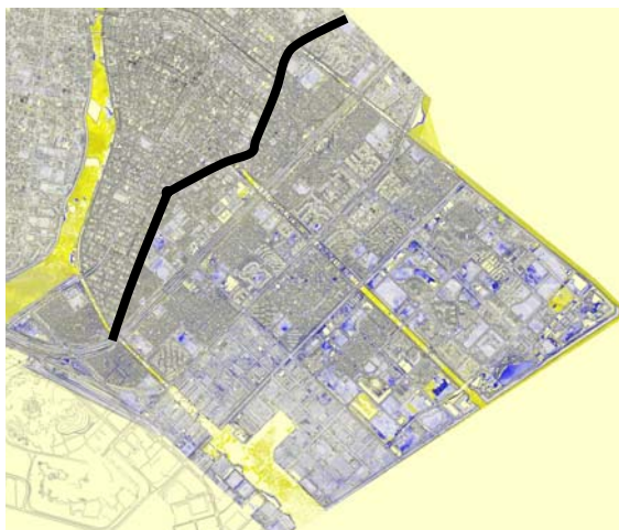
図 3. 4. 2 航空レーザ測量による浦安市の液状化沈下図 40)
