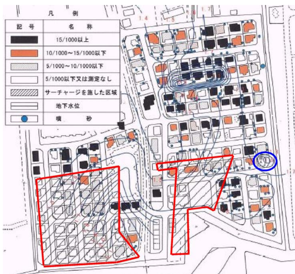
図 3.2.8 液状化被害分析図（建物被害、地下水位、地盤改良工法の重ね図）
