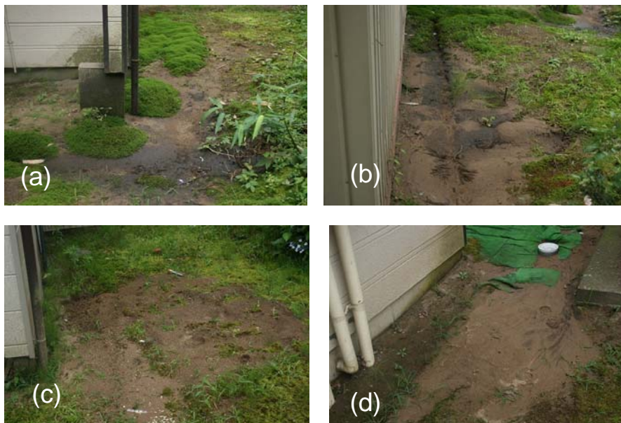
写真 3. 2. 35 噴砂痕と地表の荒れ (No. 19)
