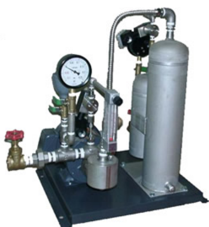
図-2.3.1 MB 水発生装置の概要 13)
