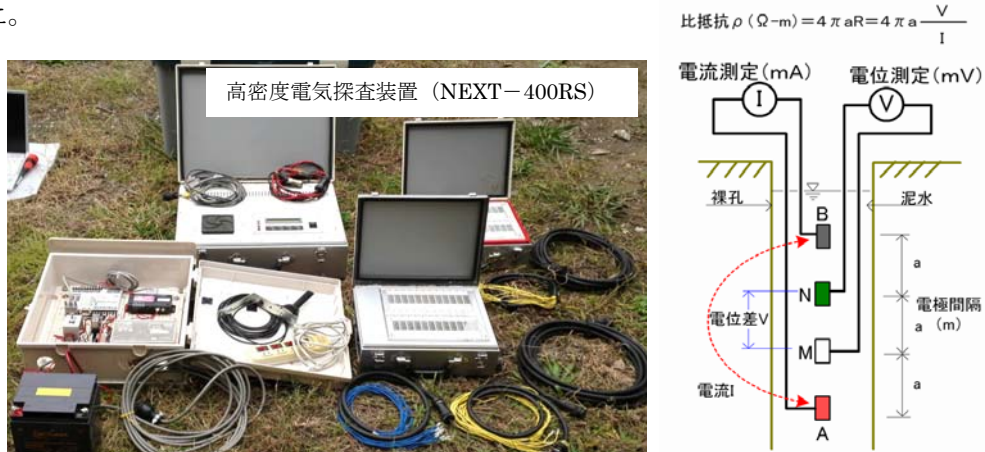
図-2.3.11 高密度電気探査装置の概要 16)
