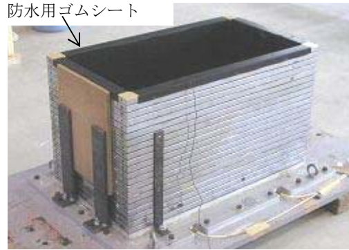
写真-2.1.1 実験に用いたせん断土層
