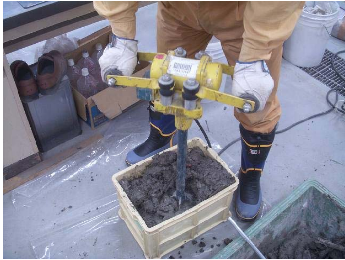
写真 7.3.2.2-4 振動締め状況
