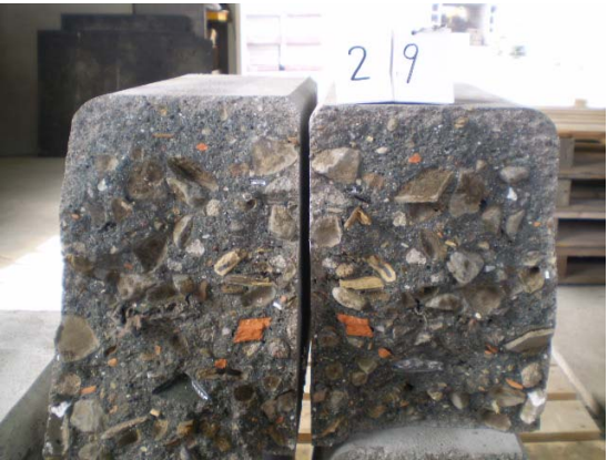
写真 7.3.1.3-19 曲げ強度試験後の破壊面の状況 (片歩 C)
