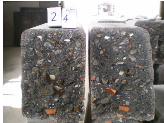
写真 7.3.1.3-18 曲げ強度試験後の破壊面の状況 (片歩 C)
