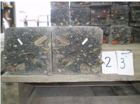
写真 7.3.1.3-14 曲げ強度試験後の破壊面の状況 (地先 A)
