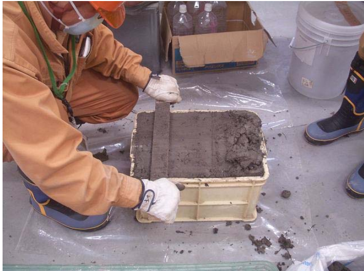
写真 7.3.2.2-5 端面整形状況
