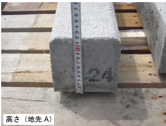
写真 7.3.1.3-8 寸法測定状況（地先 A）
