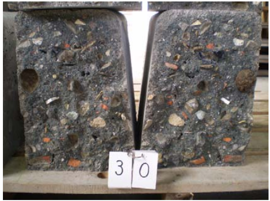
写真 7.3.1.3-19 曲げ強度試験後の破壊面の状況 (片歩 C)
