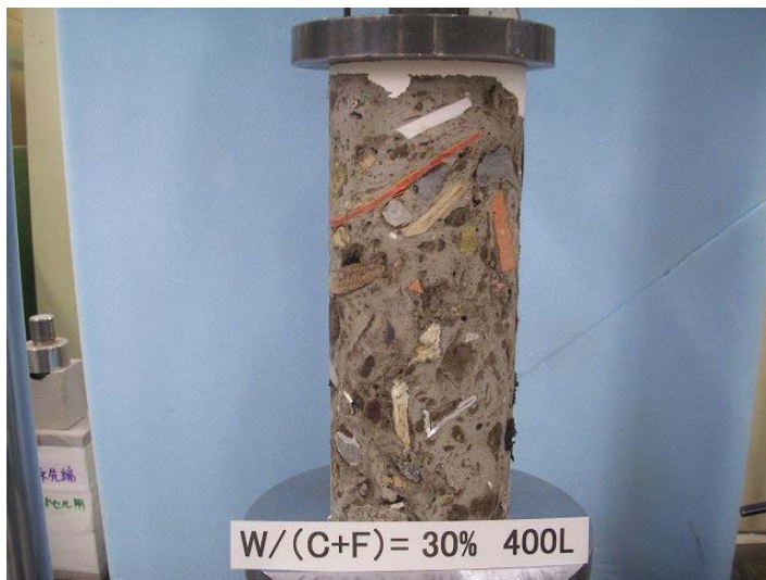
写真 7.3.2.2-9 一軸圧縮試験状況
