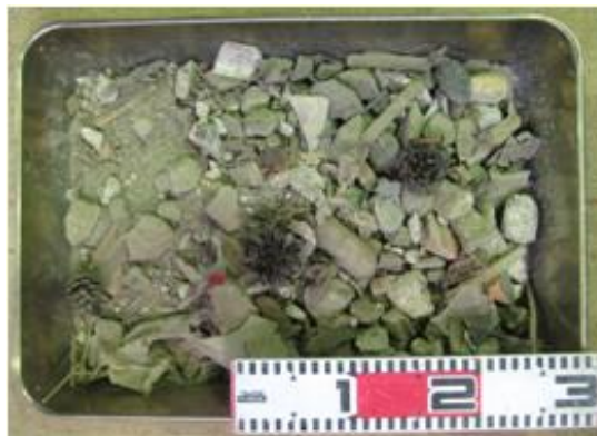
写真 7.3.1.1-1 実験に使用した1次粉砕後のがれき残渣
