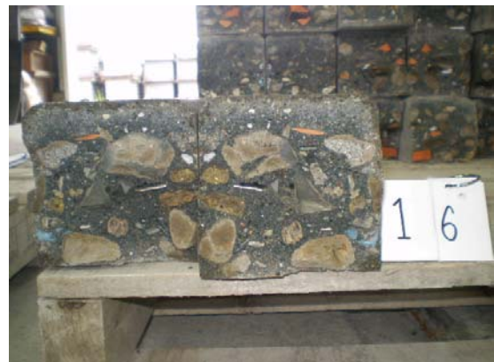
写真 7.3.1.3-13 曲げ強度試験後の破壊面の状況 (地先 A)
