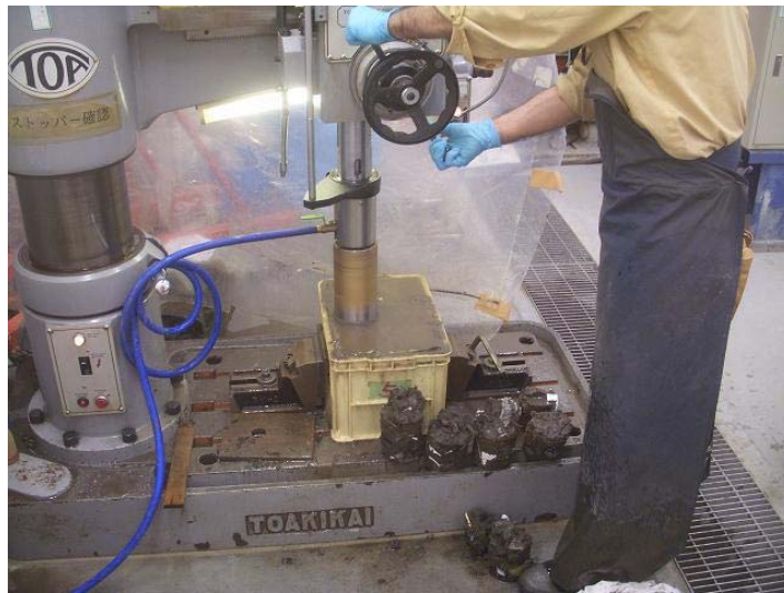
写真 7.3.2.2-7 コア抜き状況
