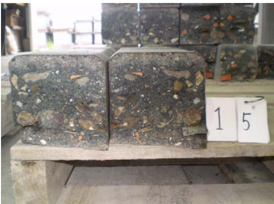
写真 7.3.1.3-13 曲げ強度試験後の破壊面の状況 (地先 A)
