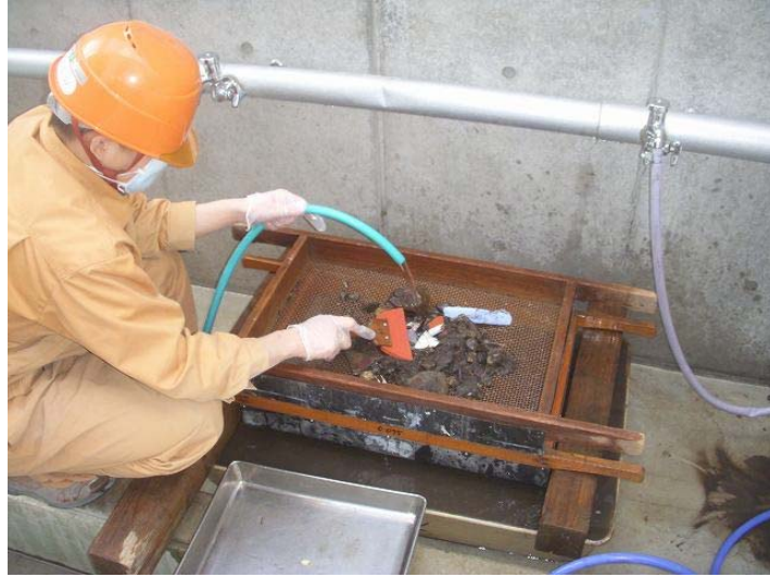
写真-7.3.2.1-8 粒度試験状況（水洗い）
