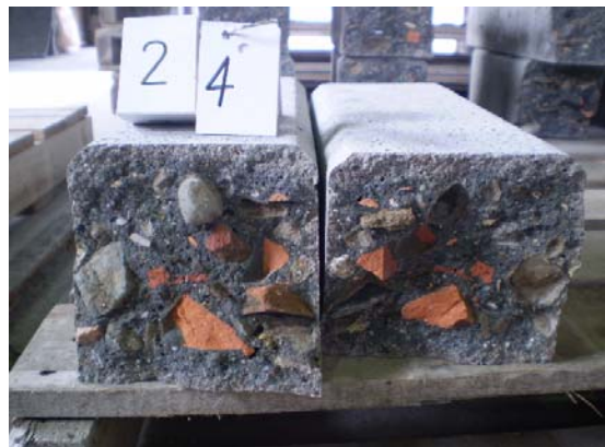
写真 7.3.1.3-14 曲げ強度試験後の破壊面の状況 (地先 A)
