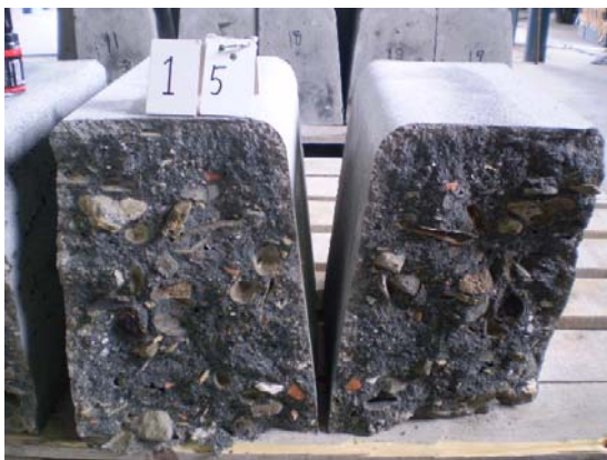
写真 7.3.1.3-17 曲げ強度試験後の破壊面の状況 (片歩 C)
