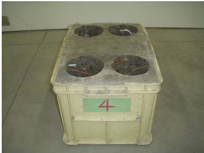
写真 7.3.2.2-8 コア抜き後のブロックの状況
