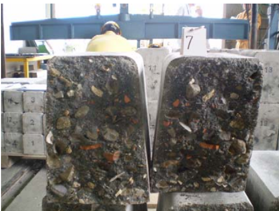
写真 7.3.1.3-16 曲げ強度試験後の破壊面の状況 (片歩 C)
