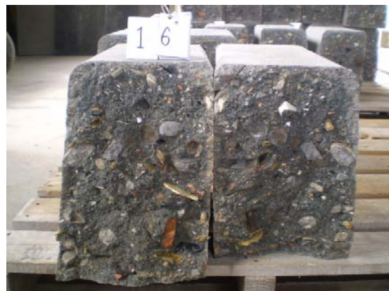
写真 7.3.1.3-17 曲げ強度試験後の破壊面の状況 (片歩 C)
