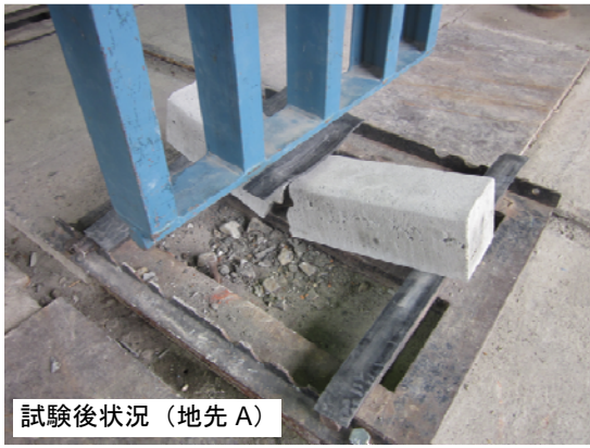
写真 7.3.1.3-11 曲げ強度試験状況
