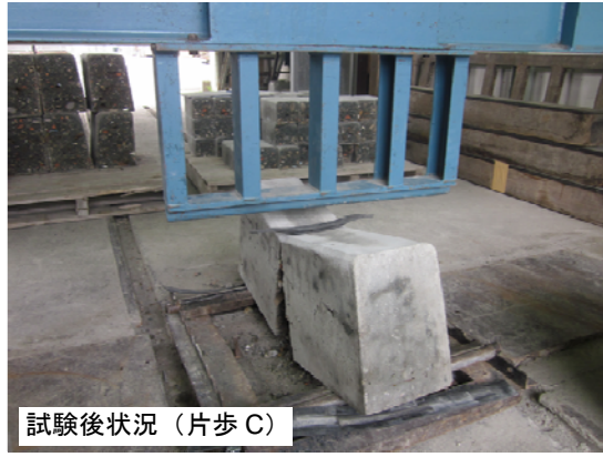
写真 7.3.1.3-11 曲げ強度試験状況
