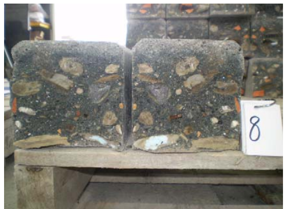
写真 7.3.1.3-12 曲げ強度試験後の破壊面の状況（地先 A）
