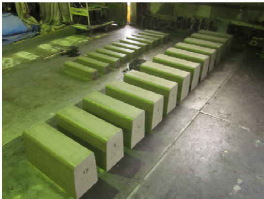
写真 7.3.1.3-6 型枠の取りはずし後の状況
