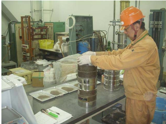
写真 7.3.2.1-9 粒度試験状況（篩分け）
