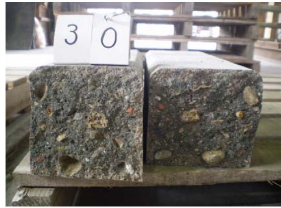
写真 7.3.1.3-15 曲げ強度試験後の破壊面の状況（地先 A）
