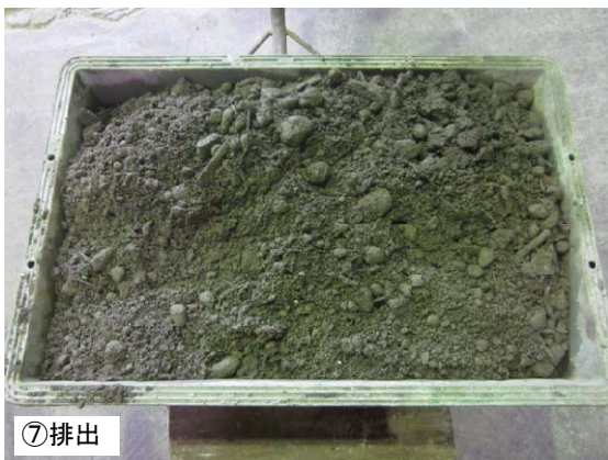
写真 7.3.1.3-2 ブロック用材料の練混ぜ状況
