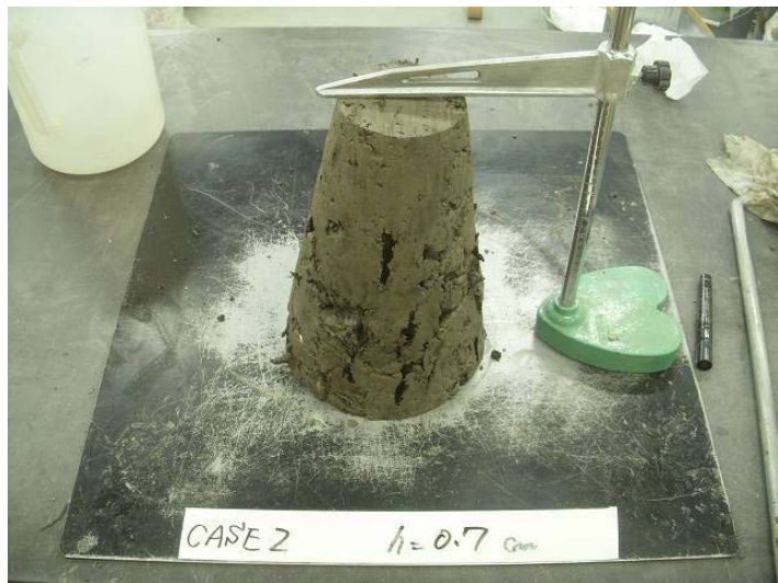
写真 7.3.2.2-3 スランプ試験状況
