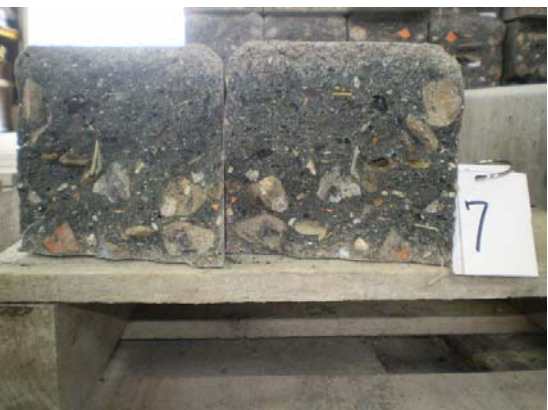
写真 7.3.1.3-12 曲げ強度試験後の破壊面の状況（地先 A）
