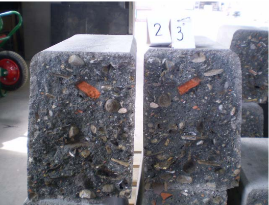
写真 7.3.1.3-18 曲げ強度試験後の破壊面の状況 (片歩 C)
