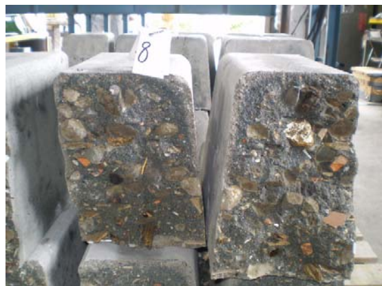
写真 7.3.1.3-16 曲げ強度試験後の破壊面の状況 (片歩 C)
