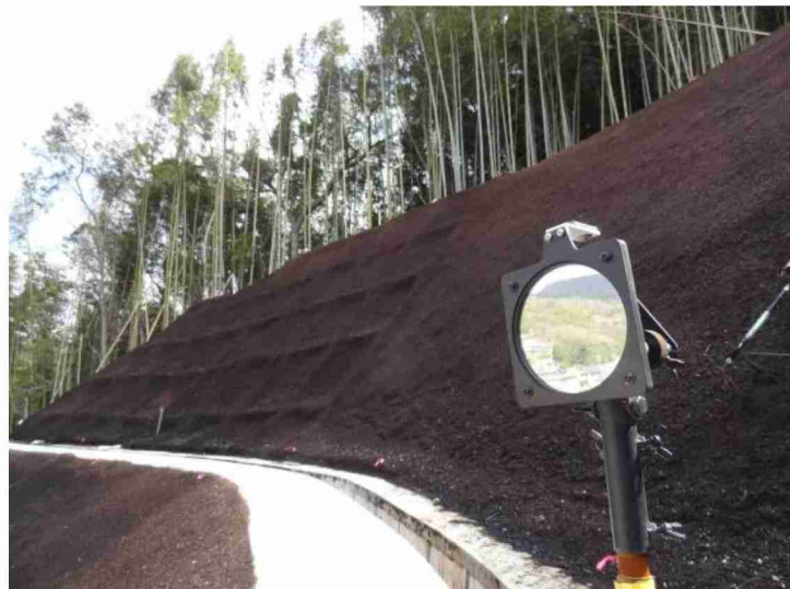
3本ねじ方式の鏡ホルダーを斜面に設置した様子。この斜面に傾斜が発生すると、約150m離れた観測点でそれを確認することができる。
