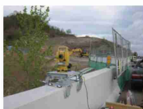
SOP(ここだけに見えるという特異ポイント)に設置した光源と簡易望遠鏡。
