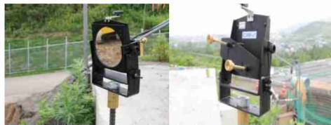
2本ねじ方式の鏡。対角線の位置にある2本のねじと、別の1点で鏡を支持し、鏡の方向を制御するシステム。
