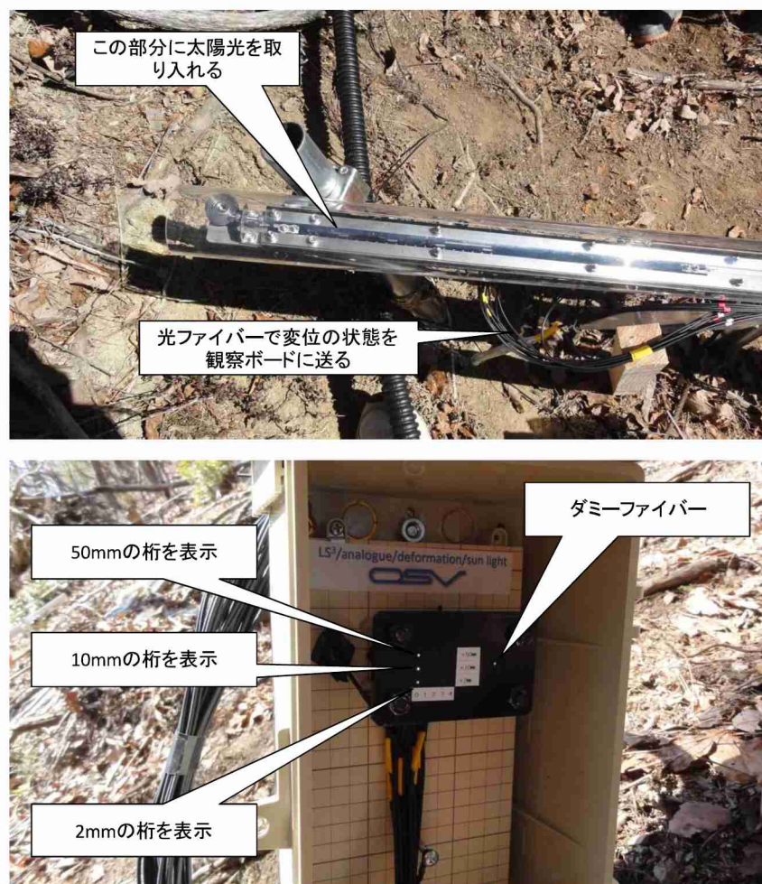
図 B4 LS 3 /analogue/sun light の構造
