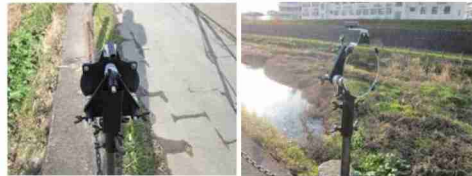
3本ねじ方式の鏡。測量器具の鉛直軸出し用3本ねじと同様の方法で鏡を支持し、鏡の方向を制御するシステム。中央部に穴を設けて、レーザーポインターなどを挿入する設計変更も可能。
