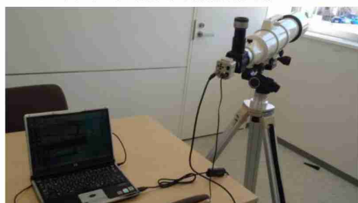
鏡の方向を初期設定する作業(従来は30分程度かかっていた)をスピードアップするための望遠鏡システム。数百m離れた場所にある鏡に何が映っているかを見ながらねじによる鏡の方向制御が必要であるため、望遠鏡の補助が必要。
