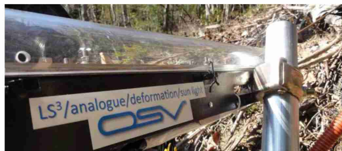
(a) 地すべり変位を光ファイバーで捉える装置
