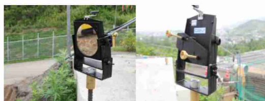
2本ねじ方式の鏡。対角線の位置にある2本のねじと、別の1点で鏡を支持し、鏡の方向を制御するシステム。
