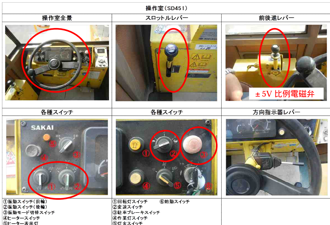
図-6.2.9 SD451 運転席内操作パネル
