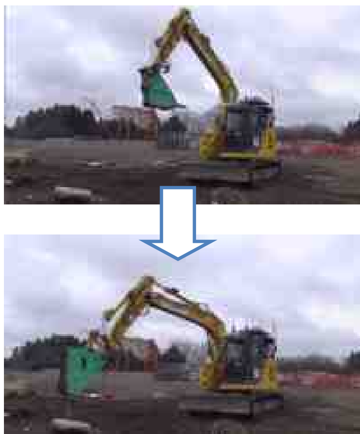
図-6.3.44 スキャン後～打撃点への制御前後の状況
