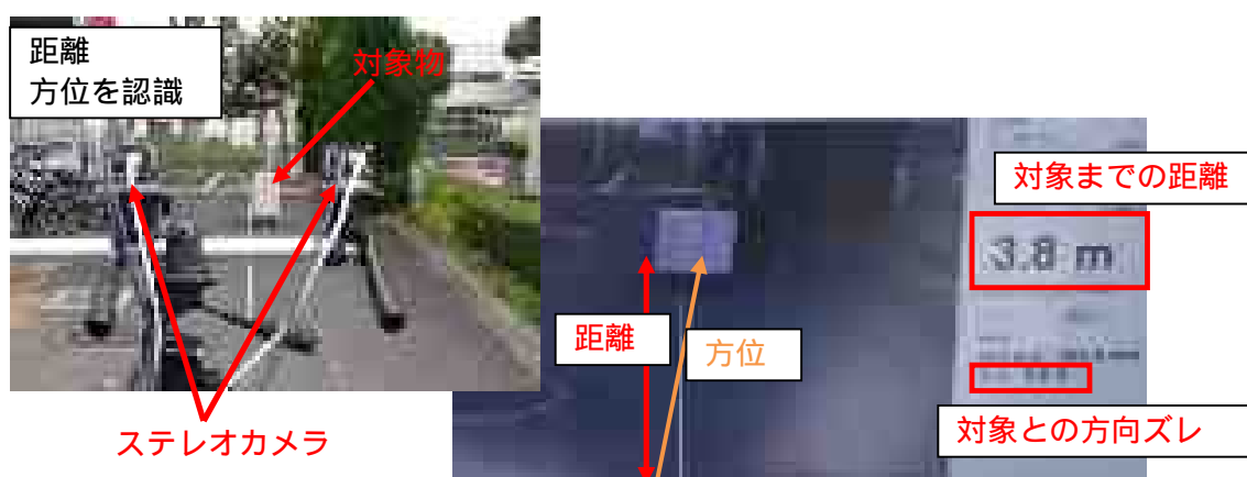
図-6.3.20 ステレオカメラによる対象までの距離・方位認識状況
