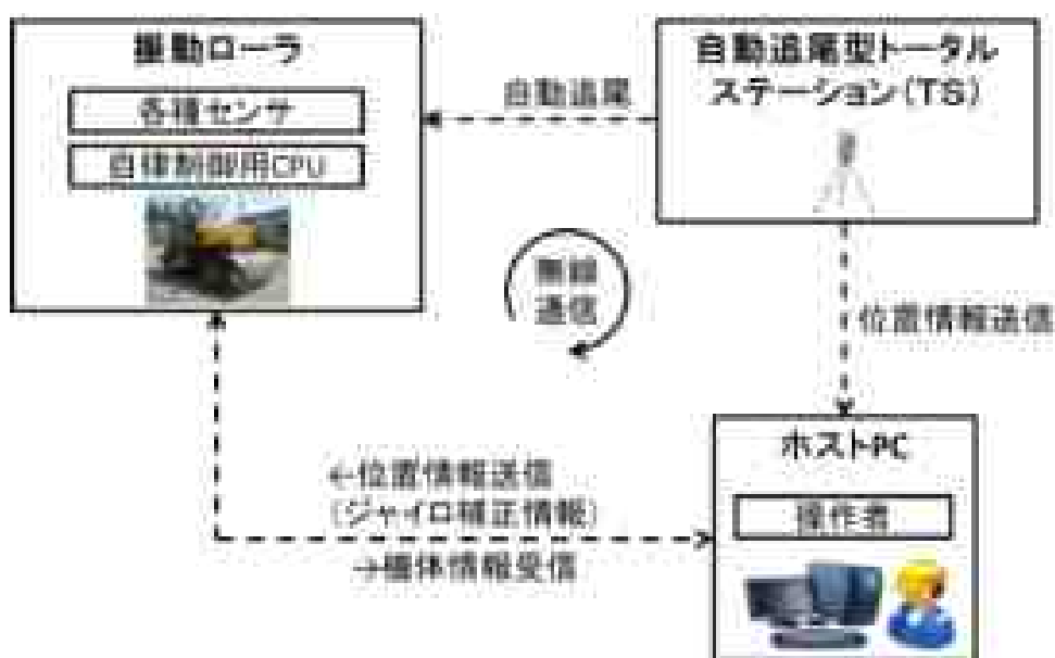
図-6.2.25 振動ローラの全体システム構成図
