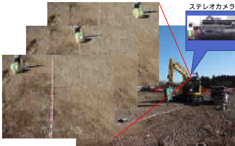
図-6.3.39 バックホウ搭載時のステレオカメラ精度検証
