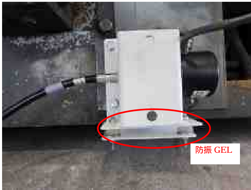
図-6.2.15 センサーの振動対策
