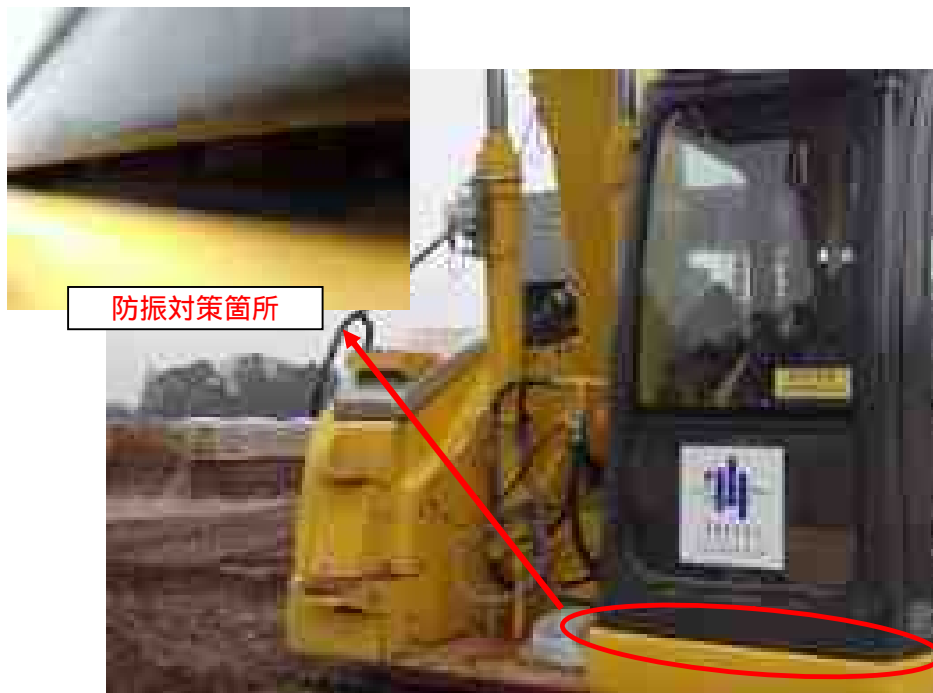
図-6.3.12 実際のバックホウでの防振位置
