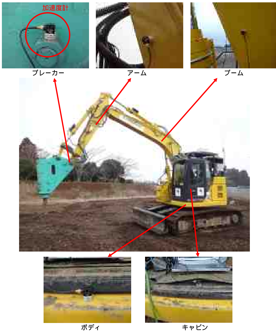
図-6.3.13 加速度計測実施箇所
