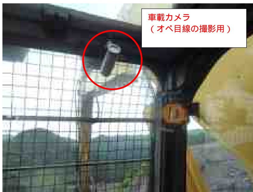
図-6.3.7 オペレーター目線撮影用カメラ
