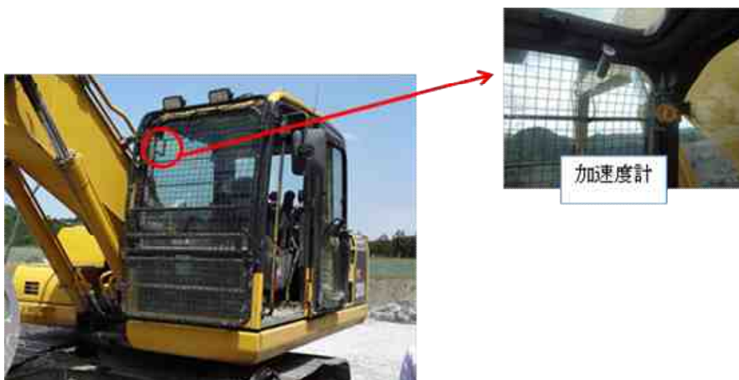
図-6.3.15 加速度計設置状況
