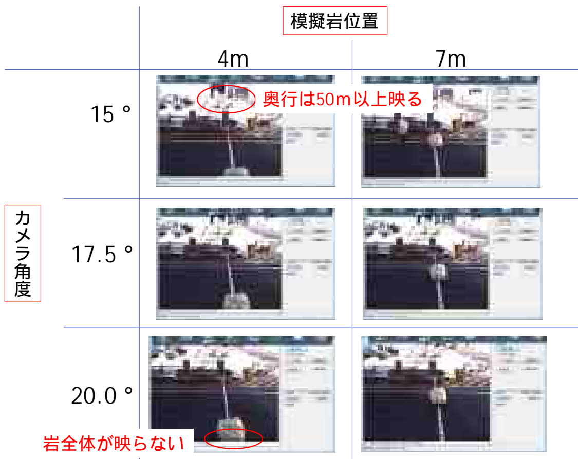
図-6.3.28 カメラ角度と視野範囲 ( 15.0^\circ \sim 20.0^\circ )
